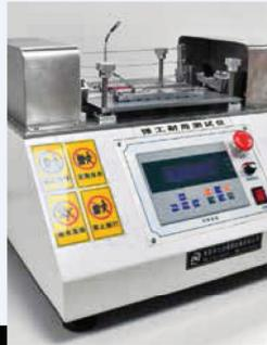
Strumento che testa la stabilità delle cerniere flex con 2.000 aperture e chiusure dell'asta.
