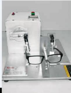
Strumento che testa la stabilità meccanica della montatura, delle aste e delle cerniere flex con 500 rotazioni delle aste.
