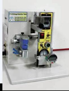
Strumento che testa la resistenza dei ponti delle montature alle deformazioni.
