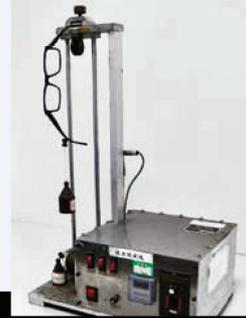
Strumento che testa la distorsione delle aste delle montature.
